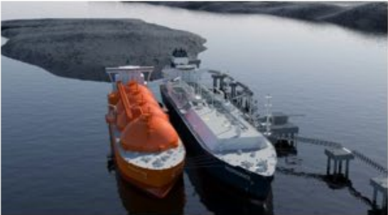
LNG Terminal (FSRU)
